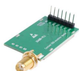
Módulo LoRa E32 900T20D 832-931 MHz
