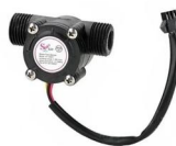
Sensor de Fluxo de Água de 1/2" - YF-S201
