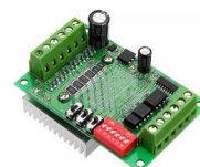
Driver para Motor de Passo 3A TB6560
