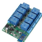
Módulo Bluetooth com Relé 8 Canais 12V BLE 4.0
