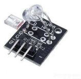
Sensor Batimentos Cardíacos Infravermelho KY-039
