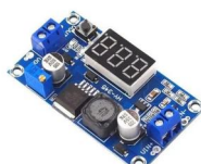
Módulo Regulador de Tensão Step Up XL6009 com Display Voltímetro
