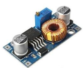
Módulo Regulador de Tensão Step Down XL4005 - Conversor DC/DC 5A
