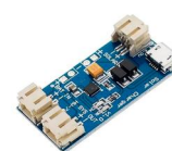
Módulo Carregador Solar para Bateria Lipo - CN3065
