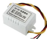
Fonte XH-M301 para Termostato XH-W1209 - Uso em chocadeiras
