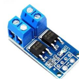
Controlador de Velocidade 5V-36V 15A 400W PMW
