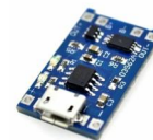
Módulo Carregador de Baterias de Lítio TP4056 com Proteção - MICRO USB
