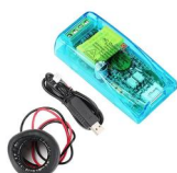
Módulo Voltímetro Amperímetro PZEM-004 V3.0 100A 260V
