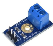
Módulo Sensor de Tensão 0-25V DC
