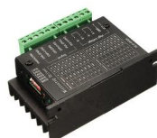
Driver para Motor de Passo TB67S109A (similar TB6600) 4A / 9-42V
