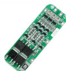
Módulo Carregador para Baterias de Lítio 18650 3S 20A 12V com Proteção HX-3S-FL20
