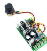
Módulo Controlador PWM 10-60V 20A - com Potênciômetro
