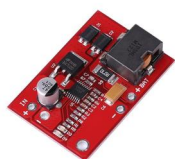
Módulo Carregador Solar para Baterias de Lítio - MPPT
