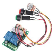
Módulo Controlador PWM 6-24 V 30 A com Reversão
