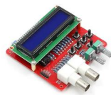
Gerador de Funções XR2206 8 MHz - Montado
