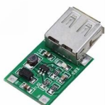
Módulo Regulador USB Step Up DC/DC - 5V
