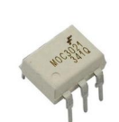
Circuito Integrado MOC3021 - Optoacoplador
