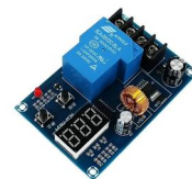
Módulo Controlador de Carga XH-M604 6-60V 30A
