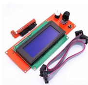
Display Controladora LCD 20x4 para Impressora 3D - RepRap SD
